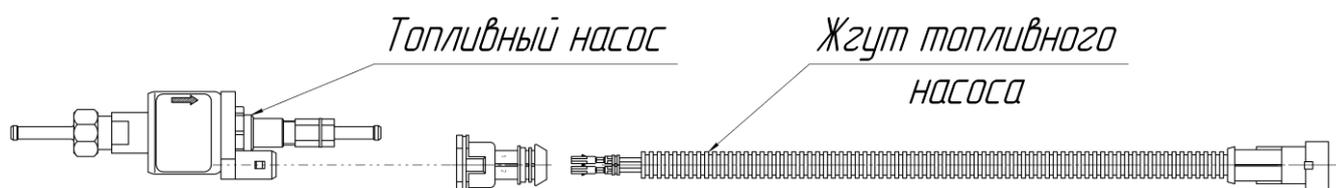
При необходимости укорачивания длины жгута топливного насоса допускается вырезка ненужной части из середины жгута. Место соединения изолируется вложенными в комплект поставки двумя термоусадочными трубками.
