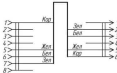
Подключение к отопителю Планар 44 производится ВМЕСТО штатного пульта при помощи прилагаемого кабеля - переходника.
