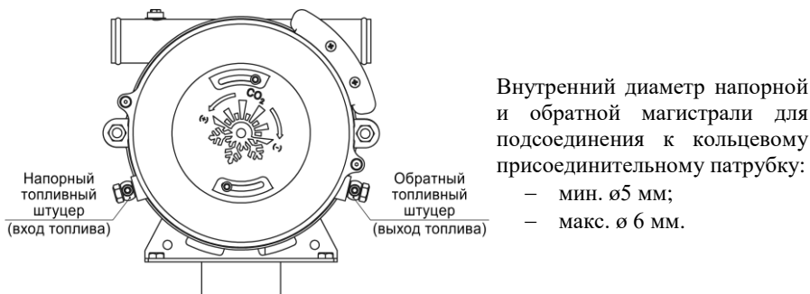
Рис.4 Подключение напорного и обратного топливопровода
